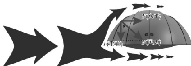
图 1 灯具抗风载设计示意图
